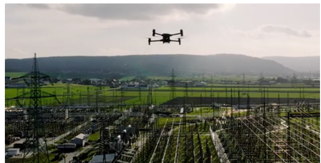
Drohnen im digitalen Umspannwerk: Smarte Inspektion für präzise Zustands- bewertung
