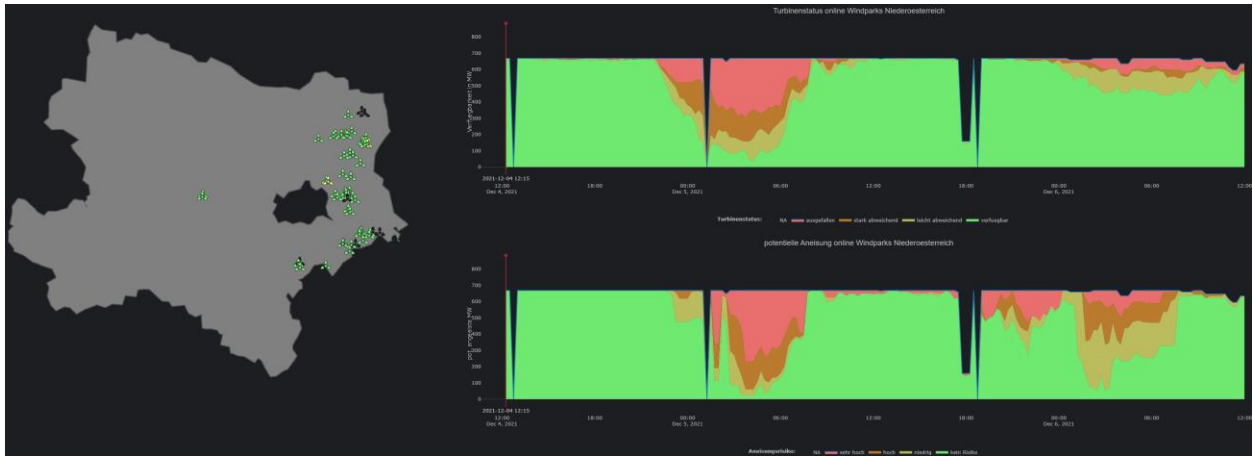
Abbildung 1: Ausschnitt Niederösterreich aus dem Überwachungsmonitor von Austrian Power Grid für die Vereisungsfälle vom 5. und 6.12.2021. Links: Niederösterreich-Karte mit den Windparkstandorten inkl. ihrer Statusinformationen im Ampelfarbensystem (Grün: „Erzeugung verfügbar“ bis Rot: „Erzeugung stark abweichend“). Rechts oben: aggregierte Übersicht über Turbinenstatus in der gleichen Region. Rechts unten: aggregierte Darstellung für Vereisungspotenzial.
